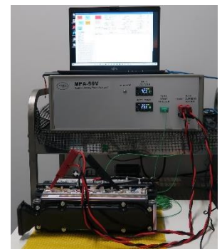
高電圧対応パルスアナライザーでの車載モジュール(16直列)特性の評価
